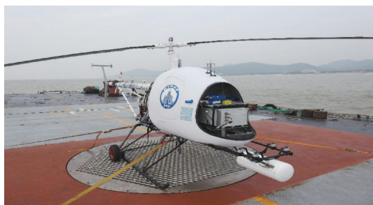
图9 船载无人机海洋观测系统
