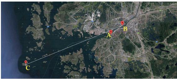
图 1 在哥德堡地区的研究区域和设备架设。图中的 A、B 两点是微波链路天线的架设位置,白色的直线是链路的传播距离为 3 km。图中的 C 点是瑞典气象水文研究所 (SMHI) 气象网站提供的位于哥德堡地区气象站站点的位置,该气象站和链路 B 端的距离为 21 km
