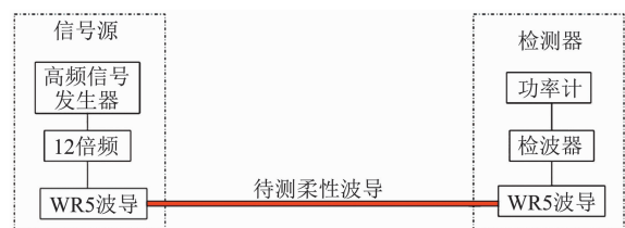
图 3 波导 G 波段损耗测量系统
