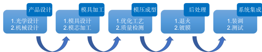
图 1 非球面光学元件的制造工艺链
