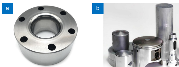
图 4 模压技术模具材料 [16] 。(a) 碳化钨材料; (b) 微晶铝材料
