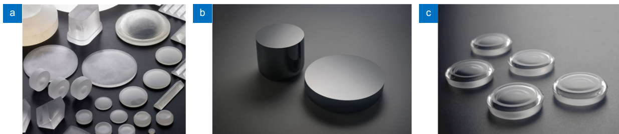
图3 光学玻璃材料 [15] 。(a)光学玻璃毛坯；(b)HWS系列硫系红外玻璃；(c)精密玻璃模压成型的非球面透镜
