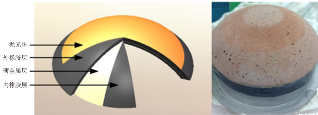
图 9 半柔性气囊结构 [20] Fig. 9 Semi-flexible bonnet structure [20]
