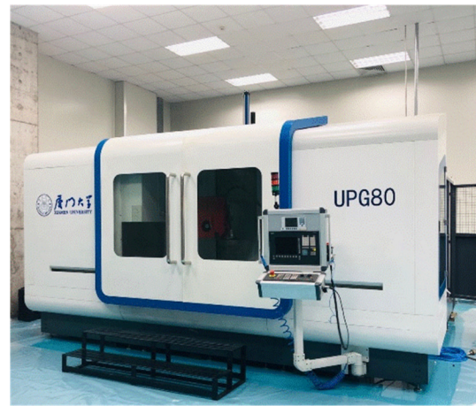
图 1 大口径精密磨床 UPG80 及机床整体钣金外观 [11]
