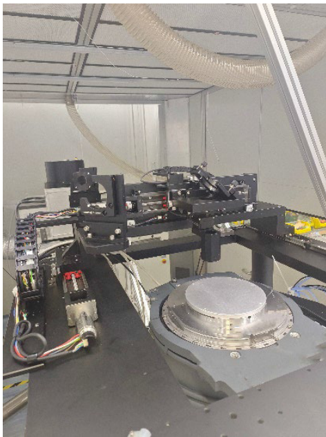
图 4 光束扫描台结构实物图
