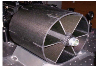
图 10 碳纤维复合材料结构样件 [39] Fig. 10 CFRP structure prototype [39]
