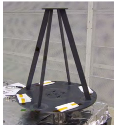
图 11 SiC 结构稳定性样件 [40] Fig. 11 SiC telescope spacer [40]
