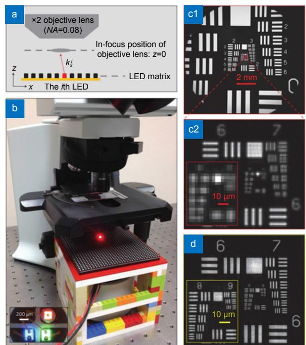
图7 傅里叶叠层显微成像系统以及 USAF 分辨率板实验结果<sup>[32]</sup>
