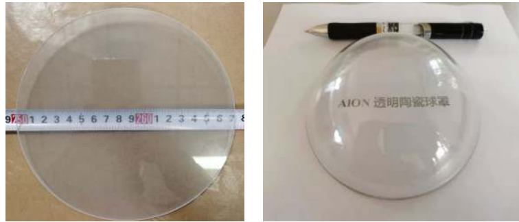
图9 基于冷等静压成型-常压烧结工艺制备的AION透明陶瓷平板(a)与球罩(b)
