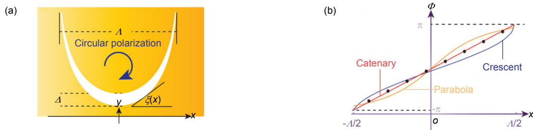
图 7 (a) 悬链线超单元示意图；(b) 悬链线相位调控特性 [39]
