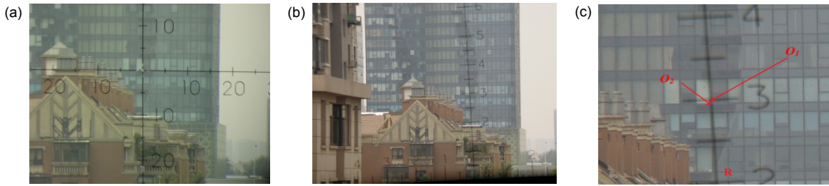
图 11 光学传感器采集图像及配准后十字分划中心位置示意图。(a) O_1 采集图像; (b) O_2 采集图像; (c) O_2 采集图像放大图
