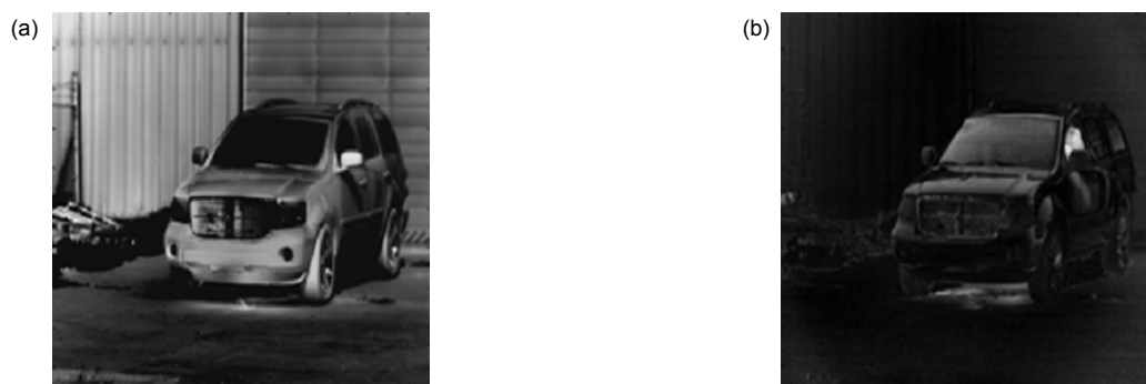
图 1 源红外光强与红外偏振图像。(a) 红外光强图像; (b) 红外偏振图像
