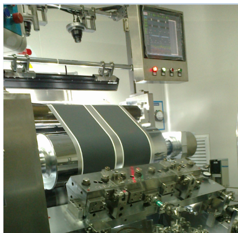
图 17 涂布测量在线检测现场
