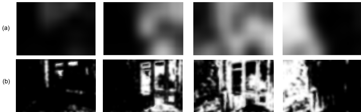
图 8 精细化后的权重图。(a) 基本层权重图; (b) 细节层权重图
