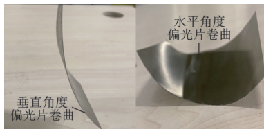
图5 偏光片易发生形变
