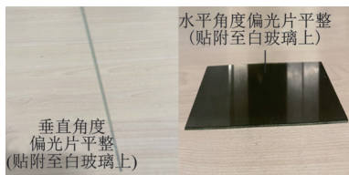
图7 偏光片贴附透过率较高的白玻璃
