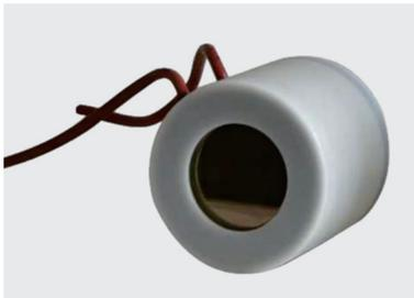
图3 SiC-HPD真空-固态混合光电探测器实物图
