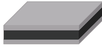
图 1 CC/MVQ-MVQ-Cu@Ag/MVQ 三层导电硅橡胶的结构示意图
