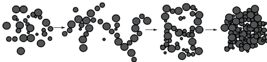
图 3 导电橡胶的导电通路形成图示
