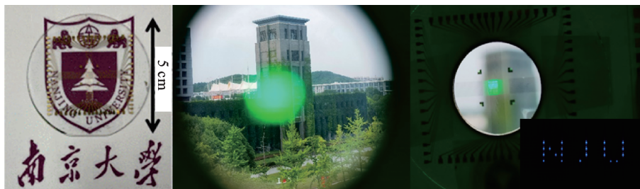
图 40 5 cm 绿光 Micro LED 透明显示屏及透明显示图像 [102]
