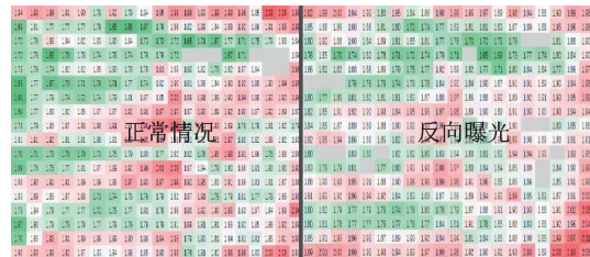
图 7 正常情况与反向曝光电极 CD 差异
