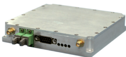
图 12 Emcore 公司直接调制型微波光子收/发模块(型号: 5021TR 系列)
