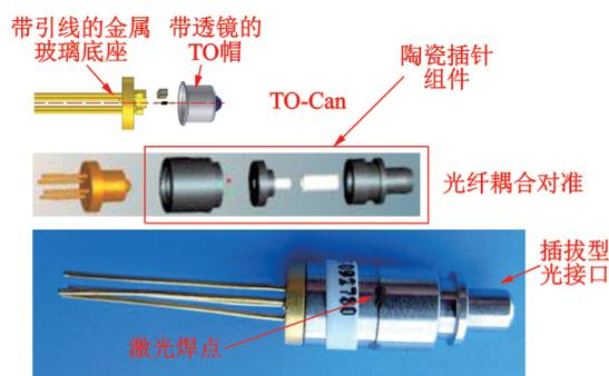
图1 插拔型同轴封装结构
