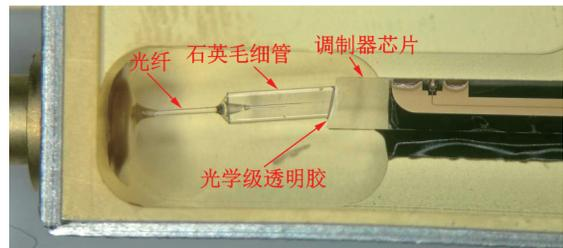
图5 光学零件的胶合
