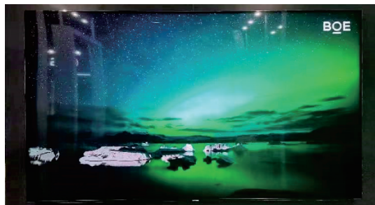
图11 BOE 218 cm玻璃基Mini-LED背光,集成了多达20 736 Mini-LED,2 304分区
