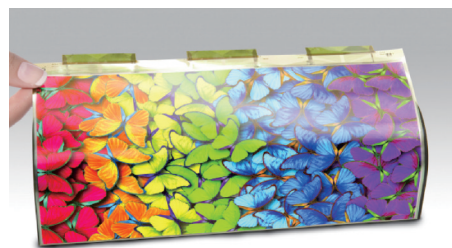
图 7 PlayNitride 与 AUO 合作实现 24 \text{ cm} 228 \text{ ppi} 柔性 Micro-LED 显示屏
