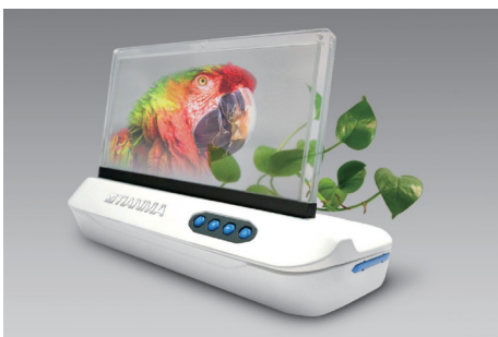
图 5 天马 LTPS TFT 驱动的 24 \text{ cm} 、 70\% 透明度、 960 \times 480 分辨率 Micro-LED 显示屏
