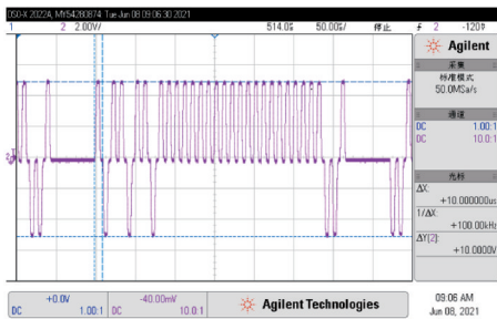
图 11 触摸控制板 HB6096 发送信号波形 Fig.11 HB6096 test waveforms of touch control device
