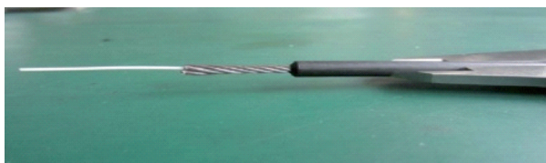
图9 钢绞线应变光缆
