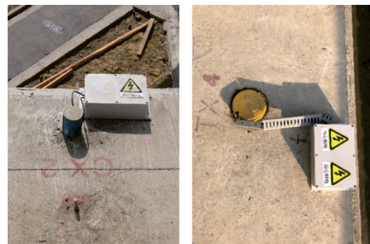
图11 布设完毕的光纤测斜点
