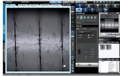
图 5 光纤光栅在 15 倍激光显微镜下形态
