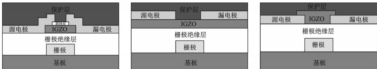
图1 刻蚀阻挡型、背沟道刻蚀型和共面型IGZO TFT
