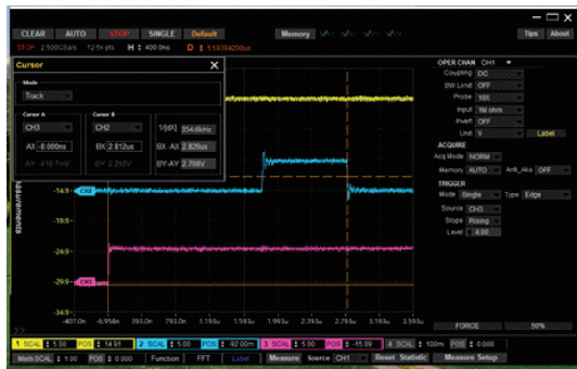
图8 外触发信号到CCD曝光开始时间差
