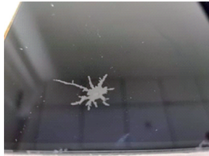
图6 液晶屏组件脱胶现象
