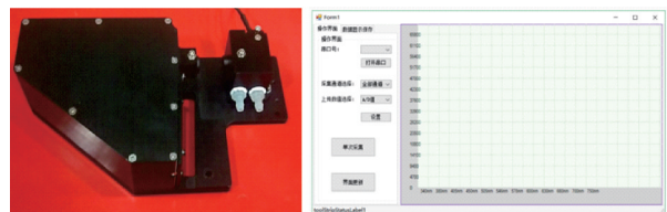
图 9 小型平像场分光光度计样机图
