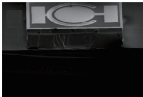
(c) 硅基光栅-InP基光电探测器键合结构SEM照片
