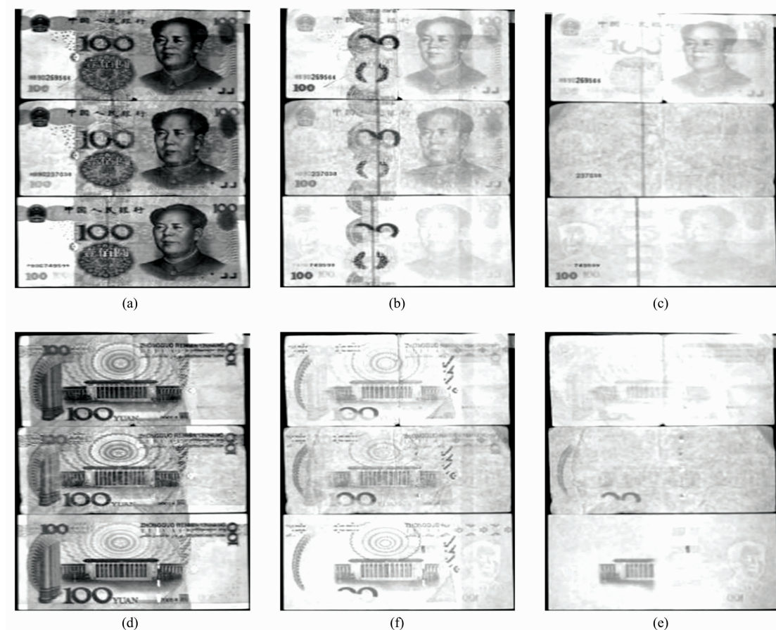
图 4 百元真钞与假钞的正反面在 500, 660 和 870 nm 的灰度图
