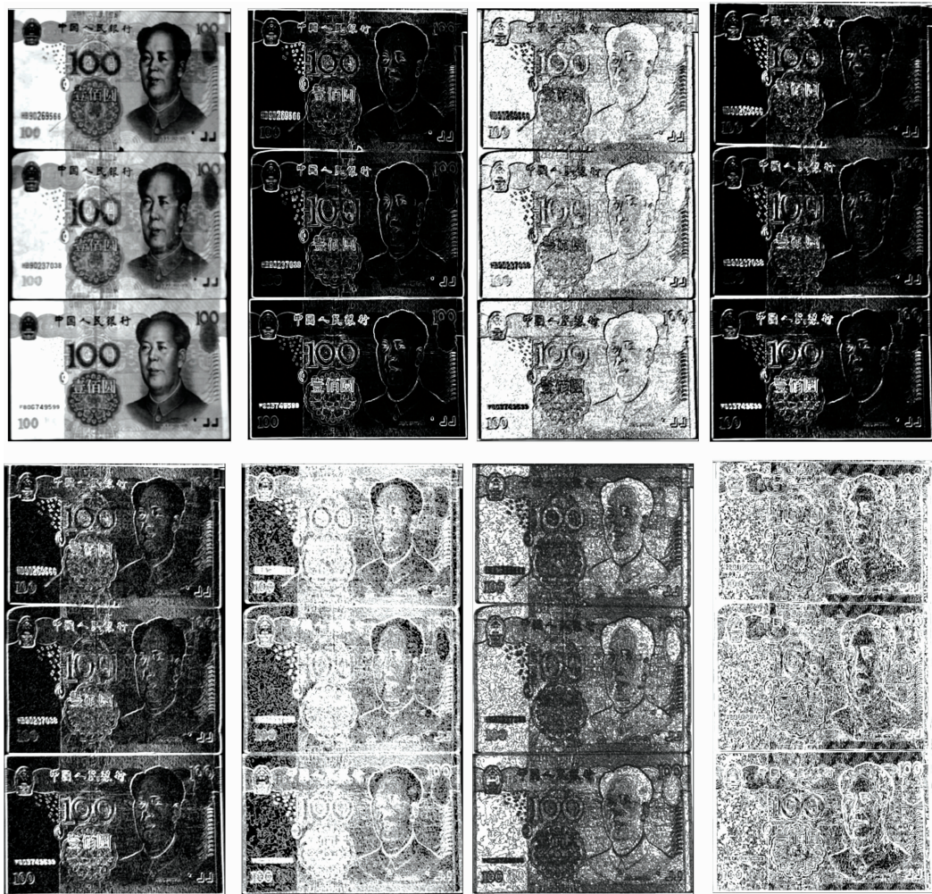
图 8(a) 真假钞正面在 550 nm 灰度图的纹理信息
