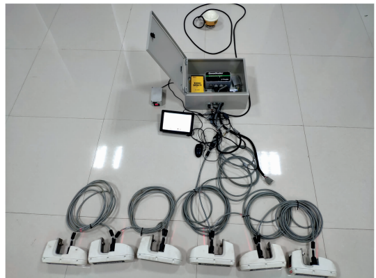
图 2 农作物冠层光谱信息采集平台
