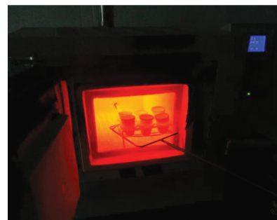
图 4 煤和岩石样本挥发分实验炉
