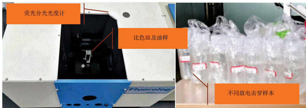
图 2 荧光双色比例变压器绝缘油品质检测原理
