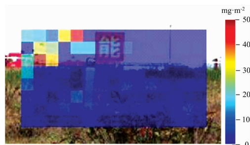
图 4 实测的 SF 6 柱浓度图像
