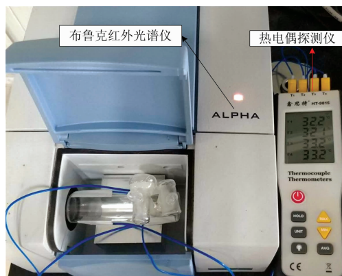
图 9 短光程气体池温度的测量
