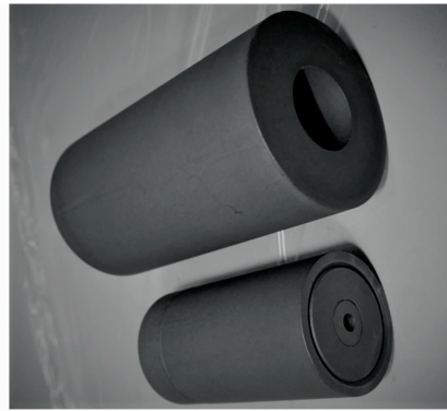
图 1 大口径与小口径 WC-C 固定点的比较
