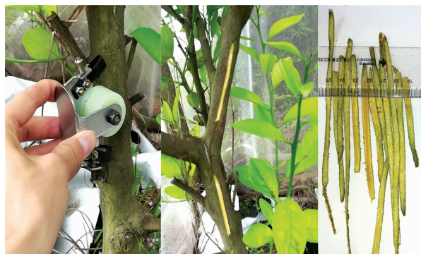
图 1 定制标准化剥皮器及所得树皮
