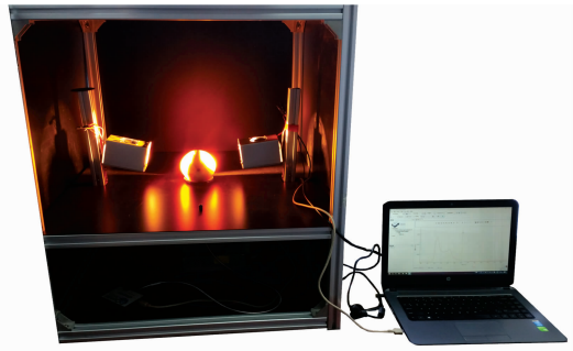
图 1 近红外透射光谱采集系统
