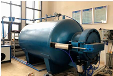
图 1 水下湿法焊接压力罐
