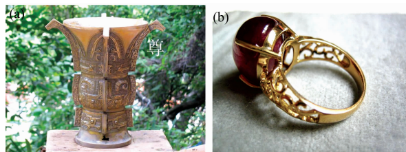
图 3 10%Sn 青铜(a)和 20 K 金(b)颜色对比图
