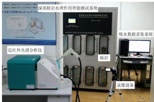
图 2 岩石吸水过程中的近红外光谱采集实验设备
