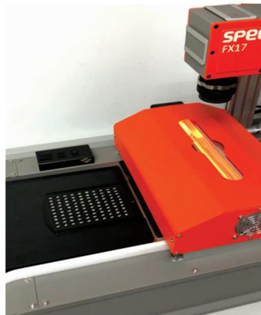
图 1 大米高光谱图像采集实验
