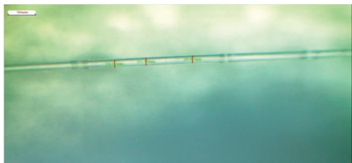
图 7 腐蚀后的传感单元显微图像
