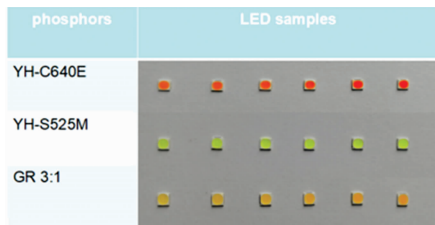
图 3 不同荧光粉涂覆的 LED 样品
