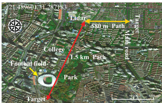
图 6 2019 年 11 月 6 日—7 日激光雷达探测路径, 路径包括公园, 居民区以及一条交通干道
