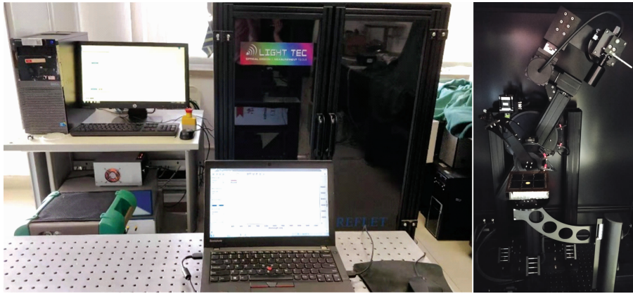
图 1 光谱反射率测量系统
