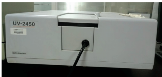
图1 UV-2450 紫外-可见光光谱仪
