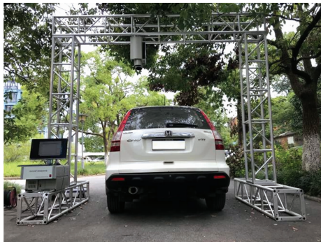
图 5 基于 TDLAS 的机动车尾气排放 CO 组分浓度遥测系统
