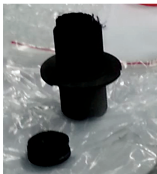
图 3 WC-C 高温固定点辐射腔、VNIIOFI 和 NIM 测量的固定点温度
